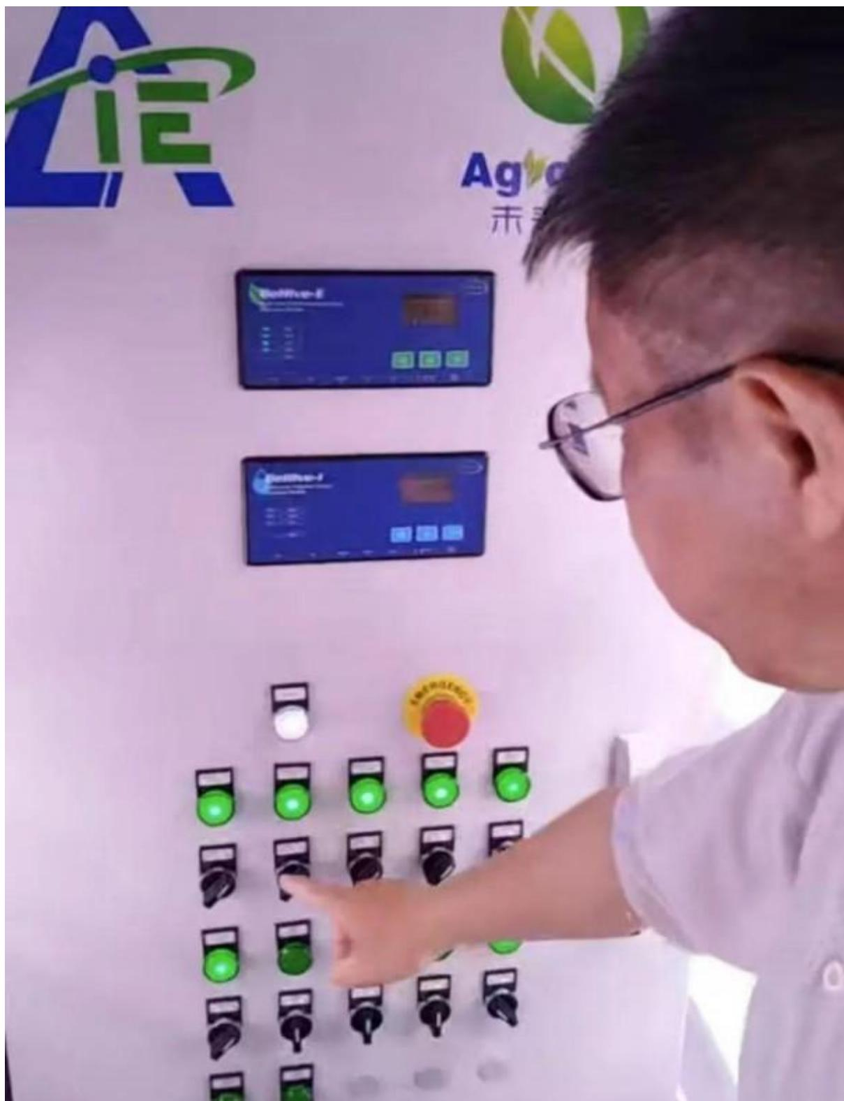
在技术结构方面，陈杰详细介绍了集装箱植物工厂的内部构造。其核心在于一套高度智能化的控制系统，可通过液晶显示屏或云端平台，对温度、湿度、二氧化碳浓度、光照和营养液等关键生长要素进行实时调控。此外，部分集装箱采用正压温室设计和高效空气过滤系统，确保内部环境洁净稳定，为植物提供最佳生长条件。这种模块化、可移动的设计，使其具备极高的灵活性和适应性。
